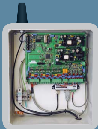
El gateway SubGate con radio
