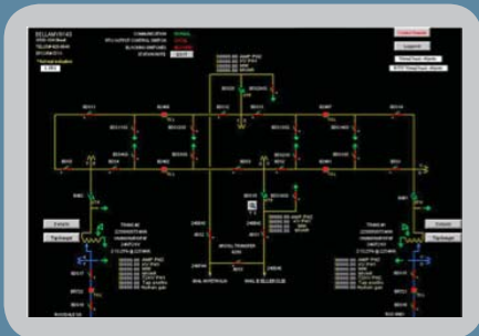
Vista de Subestación (unifilar)
